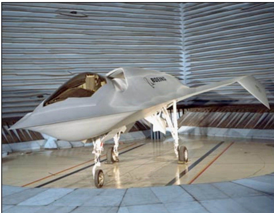
Рис. 7. Носовая часть Boeing "Bird of Prey", играющая роль ПГО.
